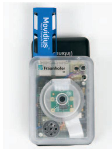
Bild 1. Embedded-Vision-Anwendung mit dem Intel Movidius Neural Compute Stick.
